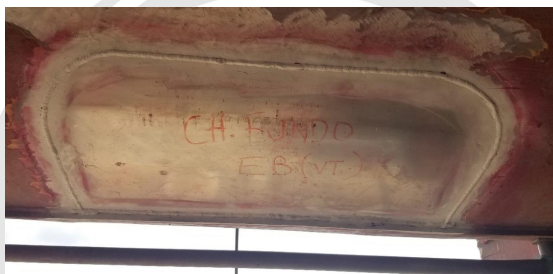
Figura 12: Reparação da fissura no casco, no exterior do fundo do Tanque de Gasóleo de EB. Foto: CV-INTERILHAS.
