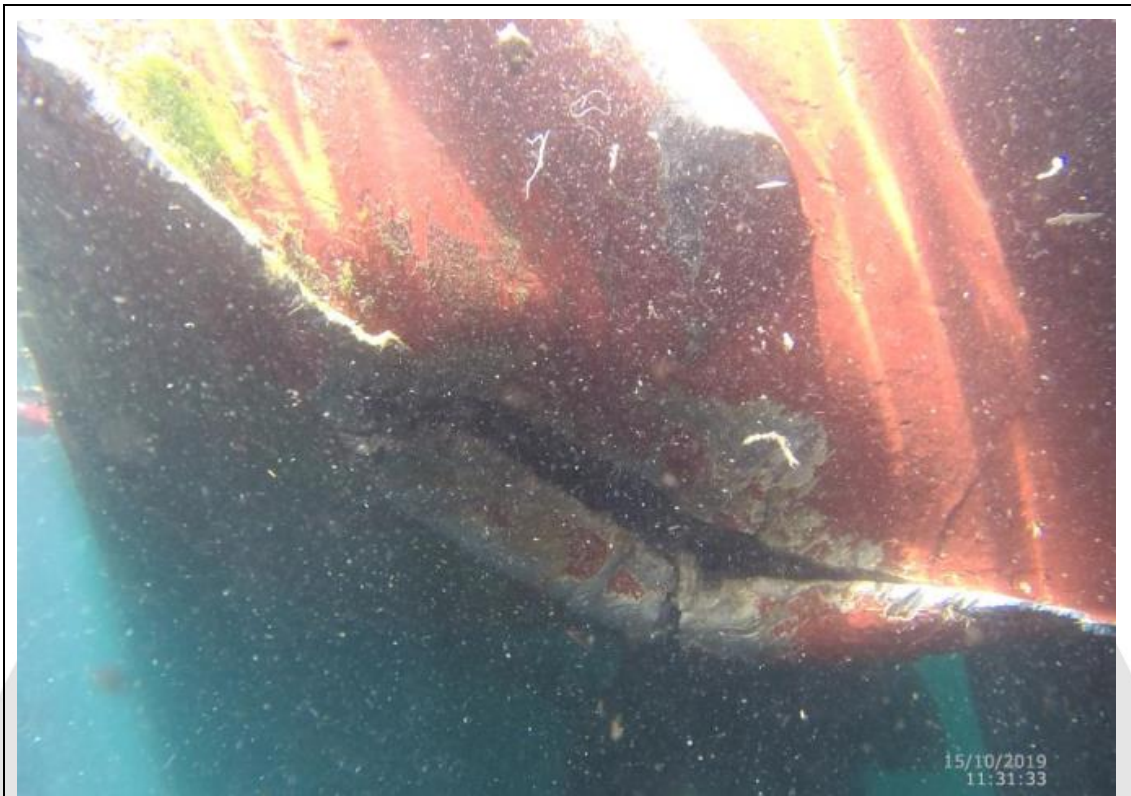
Figura 10: Rasgo no casco, lado BB da parte submersa da popa e de origem desconhecida. Foto: CV-INTERILHAS
