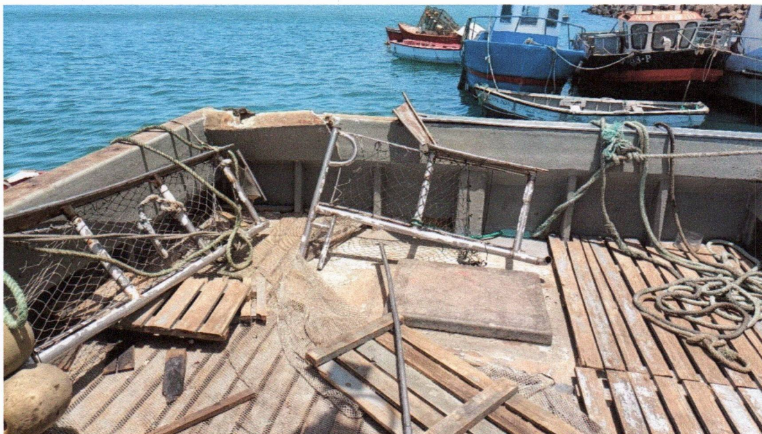
Figura 9: Danos nas obras mortas após extração(desencalhe) – convés à ré
