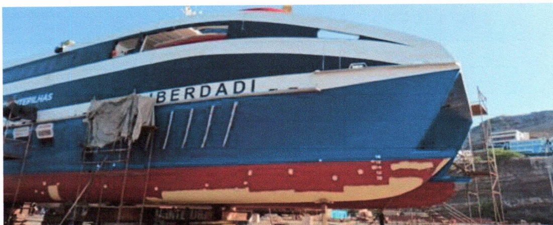
Figura 12 - Vista das chapas substituídas do lado externo do flutuador de EB
