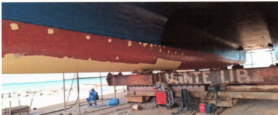
Figura 11 - Vista das chapas substituídas no fundo do flutuador de EB
