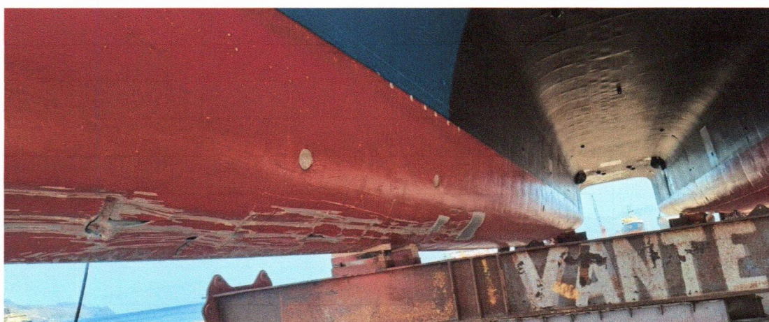
Figura 7 - Rasgos no flutuador de EB
